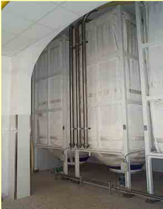
Stockage de 20 tonnes de farine dans 3 silos en tissu transpirant Trevira® installé dans le centre historique de Siena
