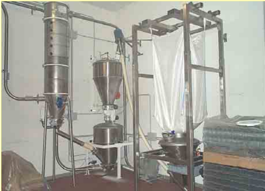
Station vide big bag pour l'automatisation du sucre installé à Lovere (SO) dans une Entreprise qui produit de la confiture.
