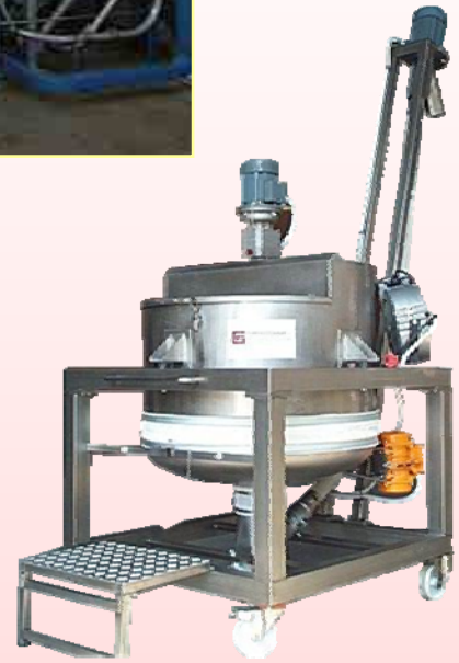
Mélangeur-doseur de semoule et farine pour la production de pâte à Foligno (PG)
