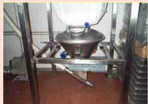
Particolare del fondo vibrante e del trasporto dello zucchero tramite coclea flessibile
