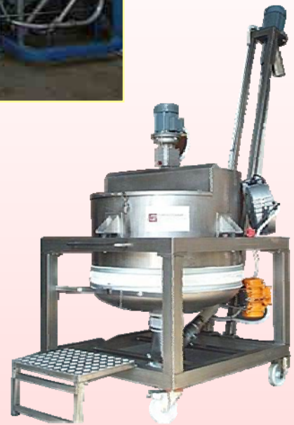
Miscelatore-dosatore di semola e farina per la produzione di pasta a Foligno (PG)
