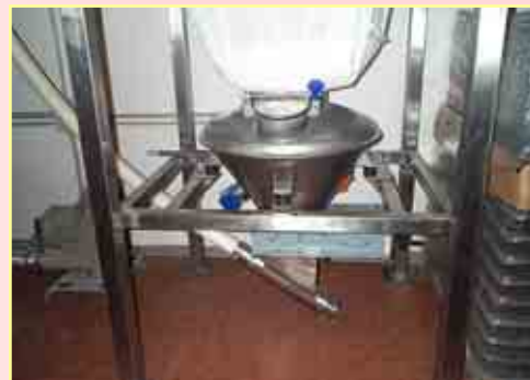
Detalle del fondo vibrante y del transporte de azucar atravez una coclea flexible.
