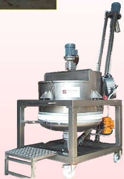
Mezclador y dosificador de semola y harina para la produccion de pasta
