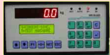
Electronica para el control de 12 silos y memorizacion de 50 formulas
