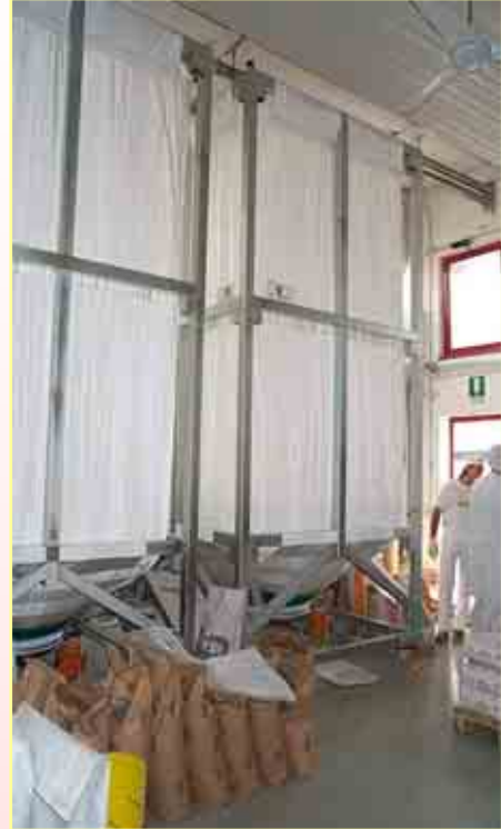
Almacenamiento de 22 toneladas de harina en 3 silos en tejido transpirante Trevira®
